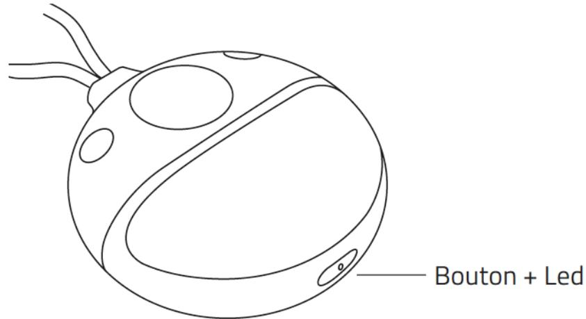
Pour le démarrer, **appuyer 1 seconde** sur le bouton situé sur le haut du capteur. Le capteur vibre et la LED du bouton se met à clignoter rapidement en bleu (1 clignotement par seconde pendant 90 secondes) indiquant la possibilité d'appairage.
