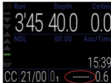
Affichage de tirets en lieu et place de la valeur de pression si perte de liaison de plus de 45 secondes avec la sonde ODC SENSOR
